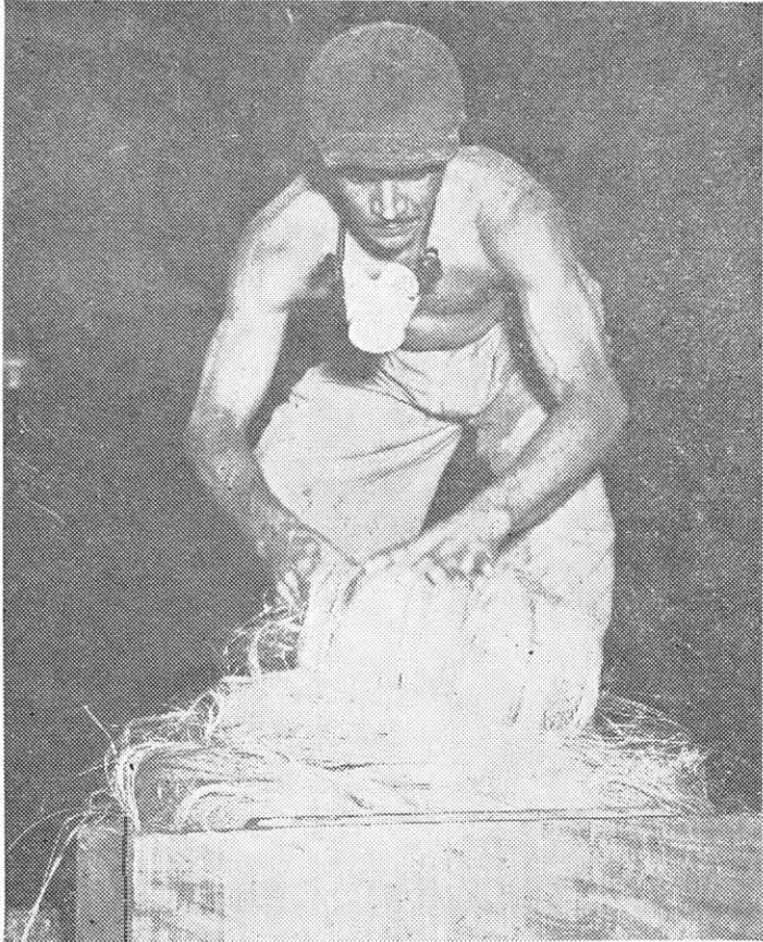
ANTONIO VALMACEDA, con habilidad y pericia, coloca la fibra blanca y seca, en el marco de madera para el embale.
